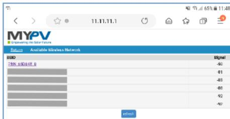
Aus der Liste das gewünschte WLAN auswählen. Das andere my PV Gerät muss über einen Router mit dem selben Netzwerk verbunden sein.
