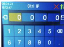
Bei einer Steuerungsart mit dem Zusatz „Manual“ darf sich die IP-Adresse der Signalquelle im Betrieb nicht verändern (beispielsweise durch einen DHCP-Router), ansonsten verliert der AC•THOR bzw. AC•THOR 9s das Steuersignal.
