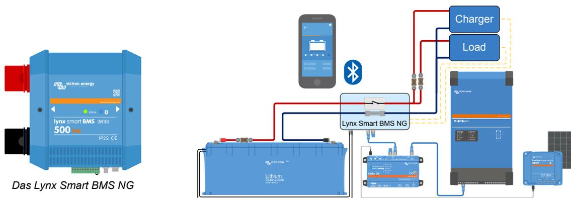
*Das Lynx Smart BMS NG schaltet Lasten und Ladegeräte über die Signale „Last trennen“ und „Laden trennen“ ab und steuert den Wechselrichter/Ladegerät über ein GX-Gerät. Sollte die Batterie noch weiter entladen werden, trennt das BMS die Batterie vom Gleichstromsystem.*
