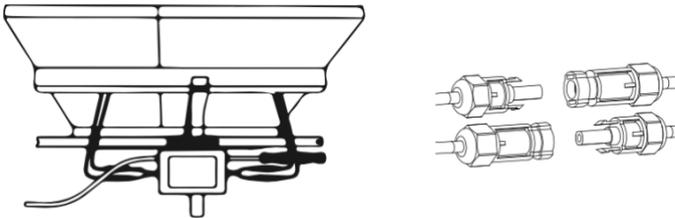
**HINWEIS:** Beim Einstecken der DC-Kabel sollte der Mikrowechselrichter sofort rot blinken und innerhalb der eingestellten Zeit (Standardeinstellung 60 Sekunden) mit der Arbeit beginnen, wenn Wechselstrom bereits verfügbar ist. Wenn kein Wechselstrom verfügbar ist, blinkt das rote Licht 3 Mal schnell und wiederholt sich nach einer Sekunde, bis Wechselstrom angeschlossen ist.
